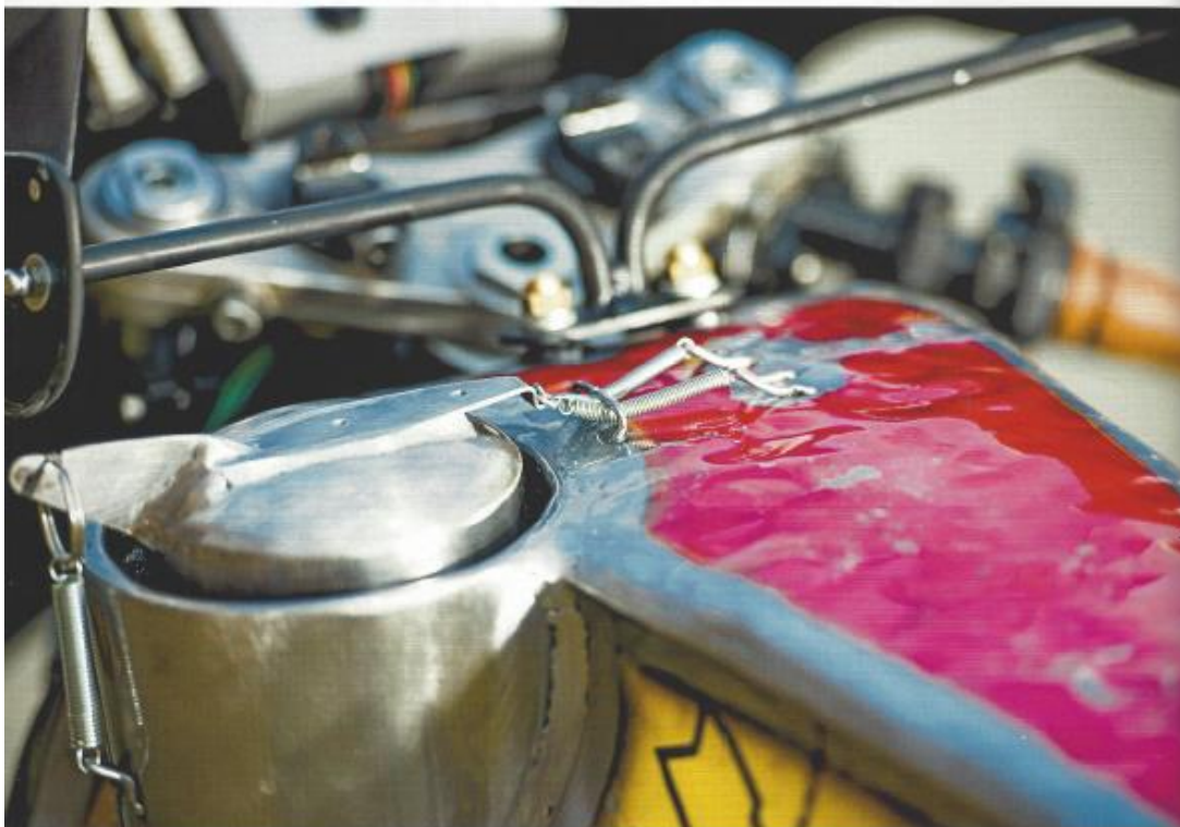
Funktional improvisiert: der Tank – mitsamt Deckel und Verschlussmechanismus ein einzigartiges Kunststück. Davor, im Cockpit, Minimalismus: Kleiner Tacho und drei Schalter für an, aus und Licht
