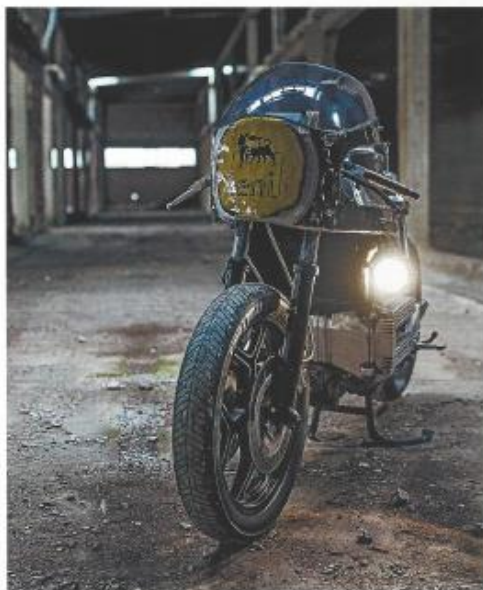
Rundgedengelte Blechverkleidung, Scheinwerfer separat an der Seite
